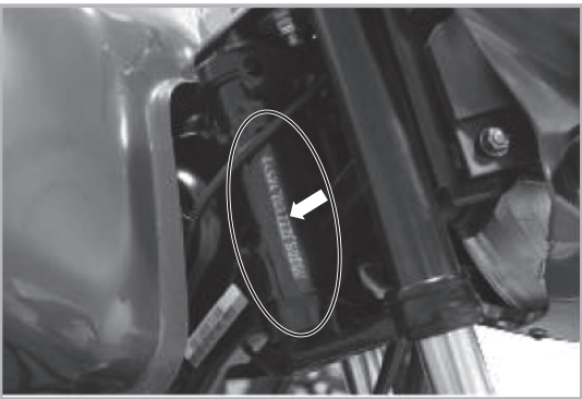
Ubicación número del motor En la carcasa izquierda cerca al pedal de cambios (Alfa-numérico – 11 dígitos)
